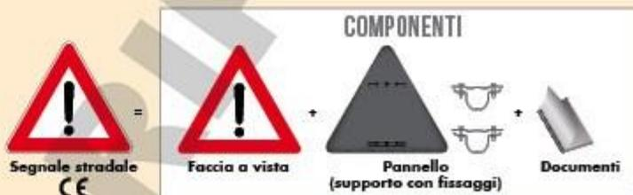
La sostituzione dei fissaggi (staffa, contro staffa e bulloni) forniti dal costruttore con altri non conformi o il montaggio senza uno dei fissaggi forniti equivale ad una manomissione del prodotto ed invalidano la certificazione del prodotto.
